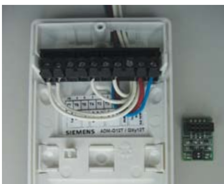
Montering med EoL-kortet
